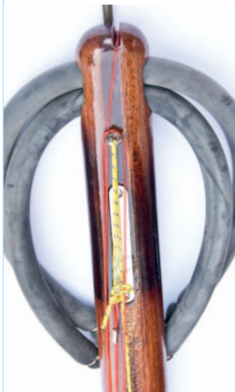
☒ Detalle de la parte inferior en la que está el alojamiento del lastre y la guía del hilo del carrete.
